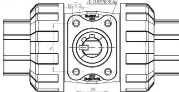
双由令球阀结构图 附加执行器支架和联轴器
